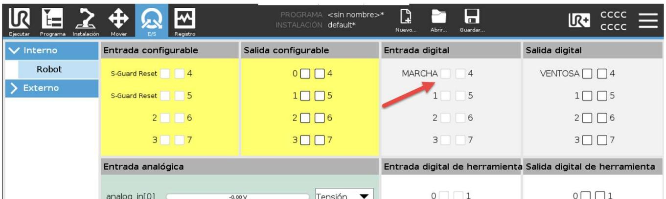
Al no poder simular las entradas digitales, podemos recurrir a realizar el siguiente truco que consiste en imitar que esperamos unos segundos hasta que se activa la entrada que forzaremos mediante una función Script
